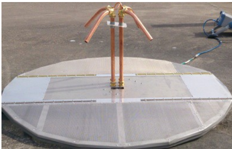
Figur 3 Bilde viser en av de kryssede dipolantennene. Totalt vil anlegget bestå av 10000 slike antenner
